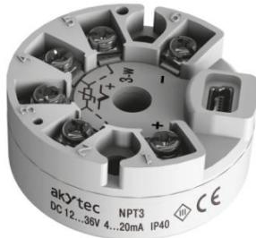
Transmiterul NPT3 are **intrare universală** și este proiectat pentru a fi montat într-un cap de conexiuni forma B. Dispozitivul convertește semnalul de intrare de la senzorul de temperatură, de tip **termocuplu sau termorezistenta**, în semnal de iesire **4-20 mA**. Configurarea este realizată prin intermediul **interfeței USB**. Nu este nevoie de nici un adaptor de programare. **Software-ul de configurare** este inclus în livrare.
