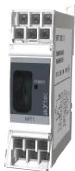
Transmitemerul NPT1 are **intrare universală** și este proiectat pentru a fi montat pe sina DIN. Dispozitivul convertește semnalul de intrare de la senzorul de temperatură, de tip **termocuplu sau termorezistenta**, în semnal de iesire **0/4-20 mA**. Configurarea este realizată prin intermediul **interfeței USB**. Nu este nevoie de nici un adaptor de programare. **Software-ul de configurare** este inclus în livrare.
