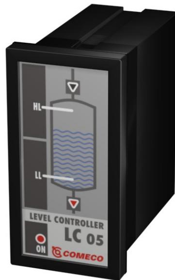
LC05 este un regulator electronic de nivel cu montare pe panou, cu pret scăzut. Prin intermediul releului de ieșire, acest dispozitiv comanda în mod direct pompe electrice, electrovalve, etc. și poate fi utilizat, fie pentru golirea (drenaj), fie pentru umplerea rezervorului (alimentare). Sunt disponibile două versiuni care folosesc metode diferite pentru măsurarea nivelului:
